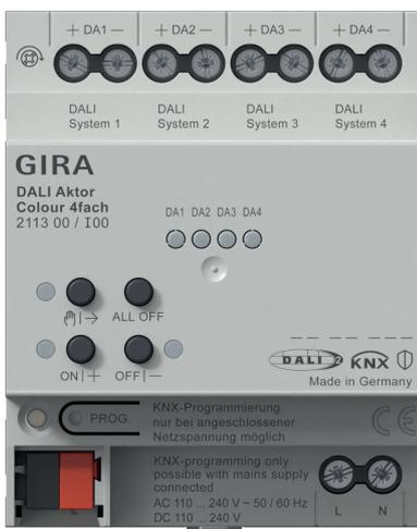
Der DALI Aktor Colour 4fach vereinfacht die KNX Integration von DALI Beleuchtungssystemen erheblich und bietet maximale Flexibilität für smarte Lichtkonzepte. Dank der Steuerung im Broadcast-Modus entfällt die aufwändige Adressierung einzelner Leuchten, so dass bis zu 128 DALI Betriebsgeräte schnell integriert werden können. Zudem ermöglichen DALI Betriebsgeräte die präzise Steuerung von Helligkeit, Farbtemperatur und farbigem Licht.
